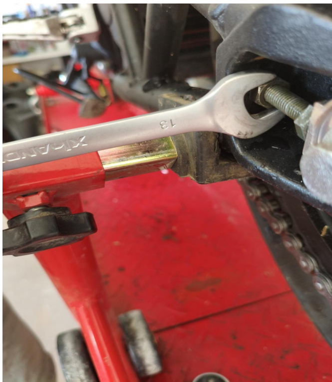
1. Resserrer le contre-écrou - clé de 13 mm
