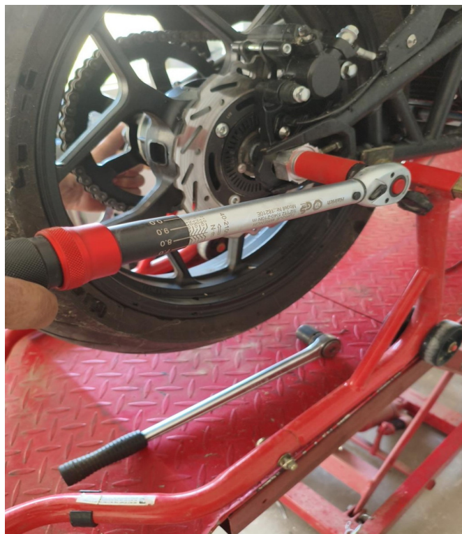
2. Serrer l'axe - clé dynamométrique
