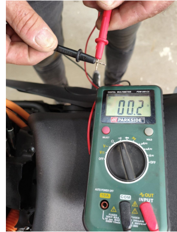
2 - Vérification : faire toucher les deux pointes. La sonnerie doit fonctionner.
