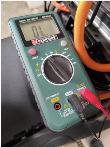
1 - Réglage du multimètre en mode continuité / sonnerie.
